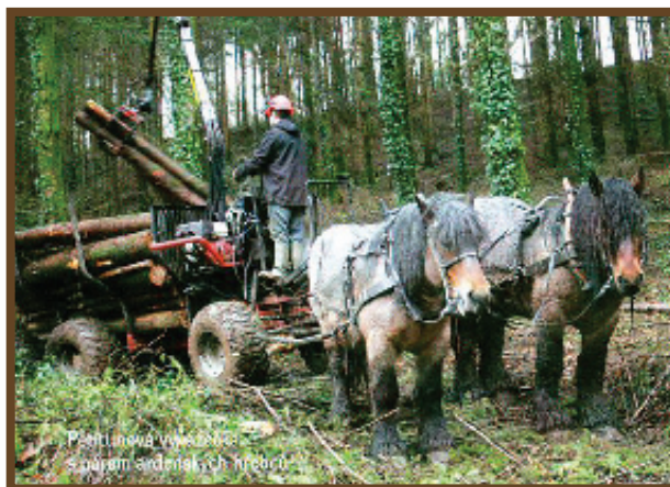
Obrázok 3 Vyvážacie zariadenie s hydraulickým nakladačom
