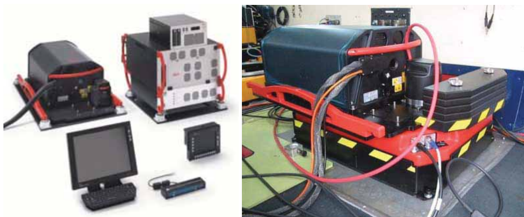
Obrázok 9. Letecký laserový skener Leica ALS 70CM a digitálna multispektrálna kamera Leica RCD 30, ktorý používa NLC
