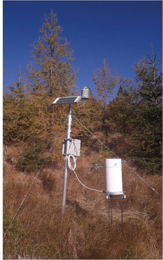
Obrázok 3. Automatická meteorologická stanica na Poľane - Hukavskom grúni (výška stožiaru 10 m) a na spracovanej kalamite pod Rakytovcom vo Vysokých Tatrách (výška 2 m)
