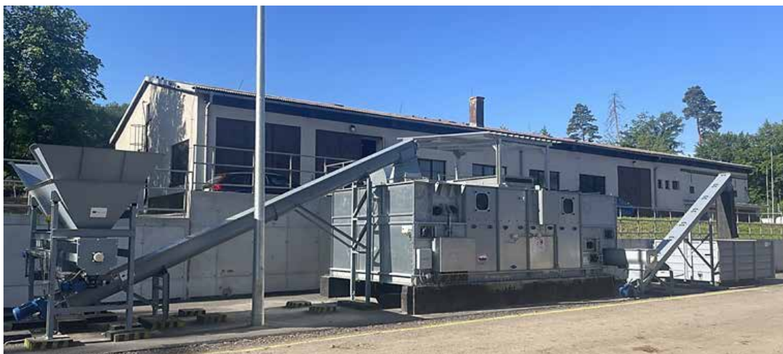
Obrázok 9. Sušička palivovej lesnej štiepky (vľavo zásobník, komora sušiarne, vpravo kontajner pre uskladnenie usušenej lesnej štiepky)
