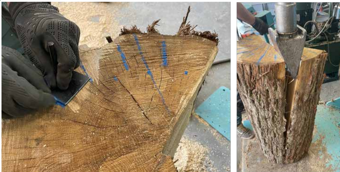
Obrázok 7. Manuálne značenie línie štiepania podľa hrúbkovej šablóny „27“
