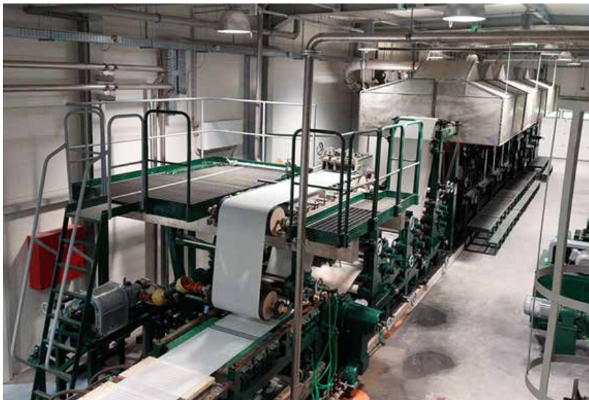
Obrázok 16. Papierenský stroj inštalovaný v areáli VS Gabčíkovo
